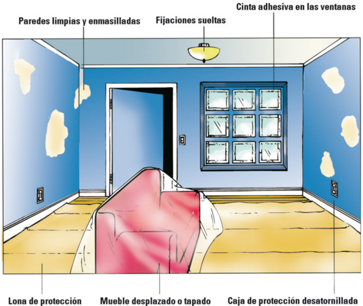
Figura 4-5: Cuando lo hayas apartado, quitado o limpiado todo, puedes empezar a pintar
