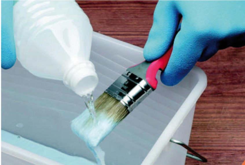
Figura 4-14: Limpieza del pincel
