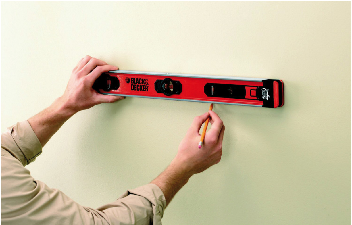
Figura 3-3: El marcador permite obtener una línea recta
