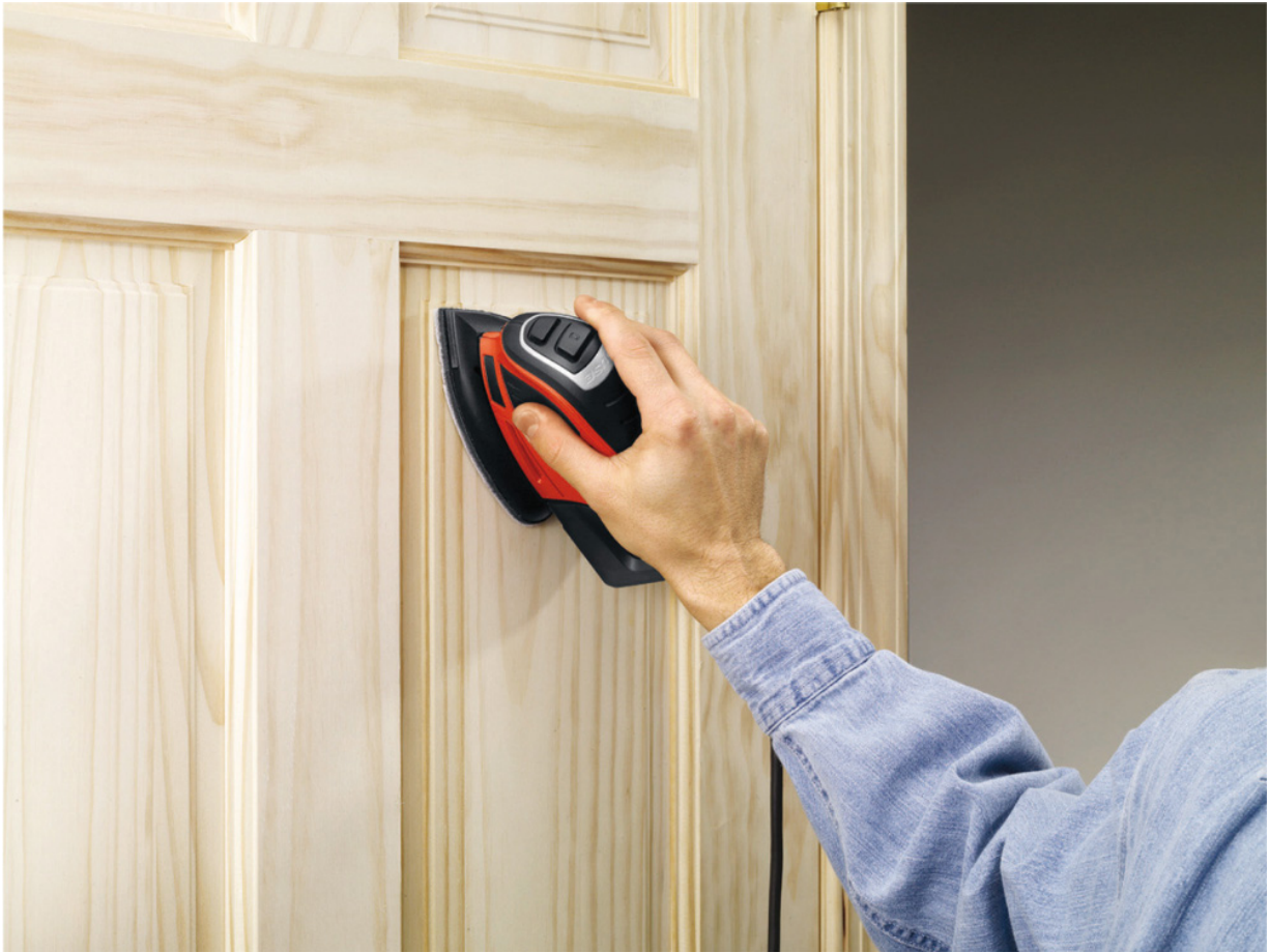
Figura 6-3: Haz todos los movimientos en el sentido de las vetas de la maderas
