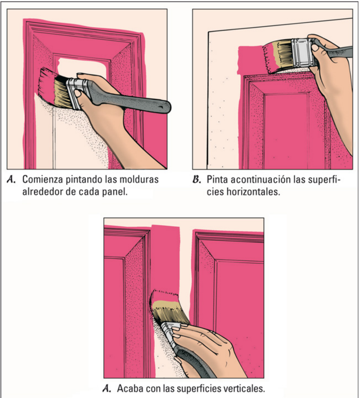
Figura 4-15: Pintar una puerta con paneles
