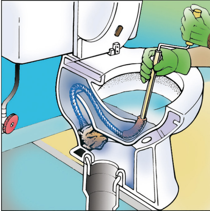
Figura 11-8: Utiliza un tubo flexible especial para deshacer el tapón del sifón de la taza
