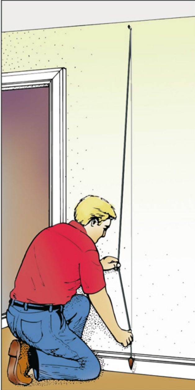
Figura 7-3: Una plomada te permitirá determinar una vertical
